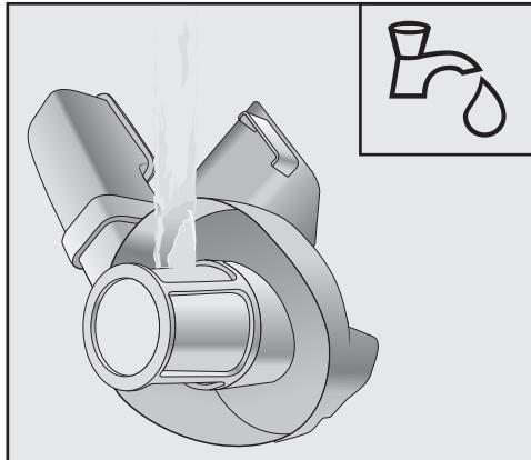
■ Очистите фильтр предварительной очистки под холодной проточной водой.
