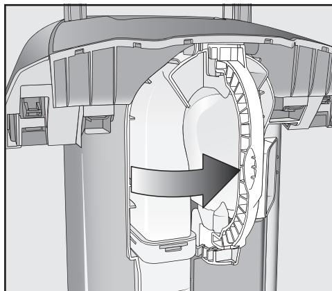
■ Разблокируйте ручку фильтра предварительной очистки и выньте его.
