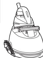
fig. 9: Almacenamiento del cable
