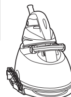
Fig. 9: Armazenamento do cabo
